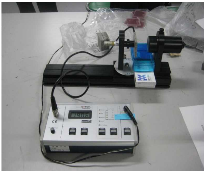
図A 実験状況 No1 (サンプル 1 枚遮蔽試験)
