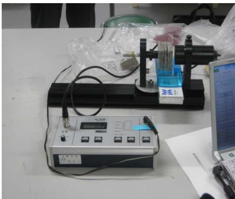
図B 実験状況 No2 (サンプル 5 枚遮蔽試験)
