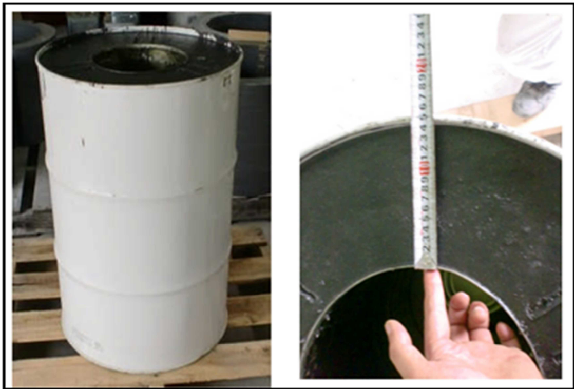
図4 TV鉛ガラス放射線遮蔽容器(例)
